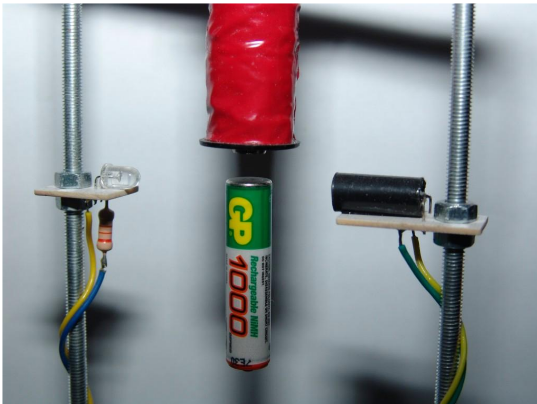
Obrázok 5 Levitátor s využitím optickej brány
